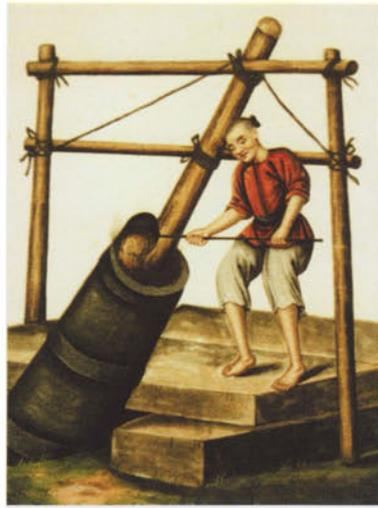
图版 13、图版 14 炮的模范制作和铸造
